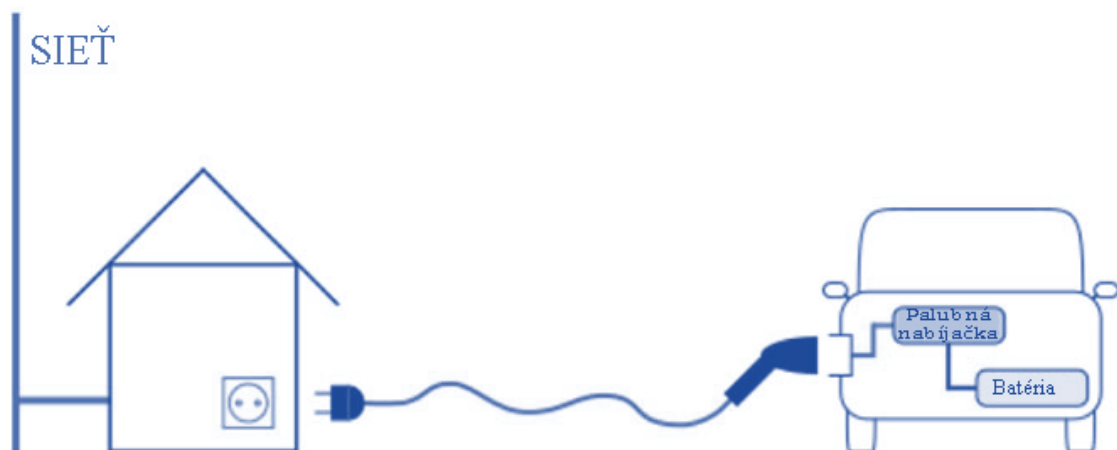
Obrázok 3 Schéma pripojenia elektromobilu v režime 1 [21]
