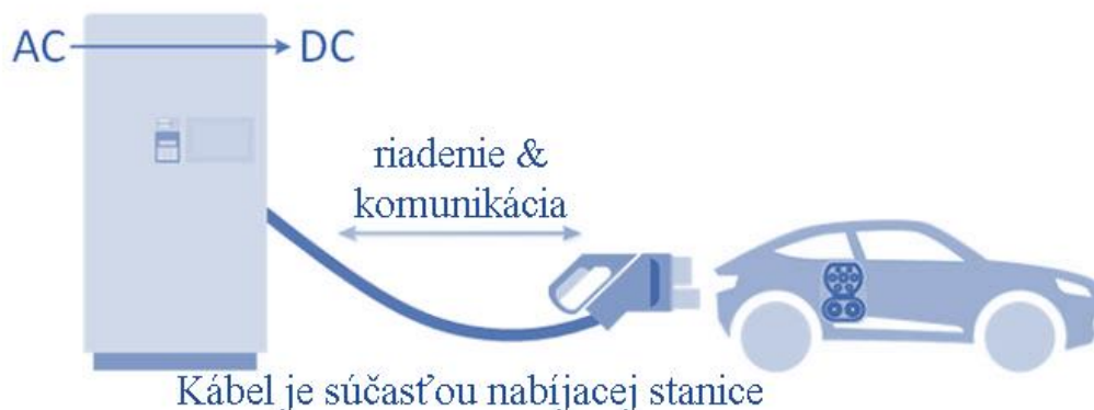
Obrázok 6 Schéma pripojenia elektromobilu v režime 4 [21]
